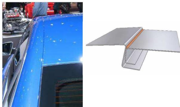
図2 自動車のドアとルーフのレーザーろう付
